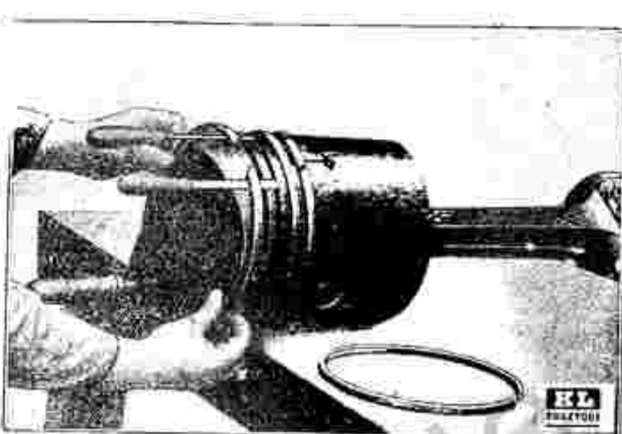
Fig. 52. Removing piston.
