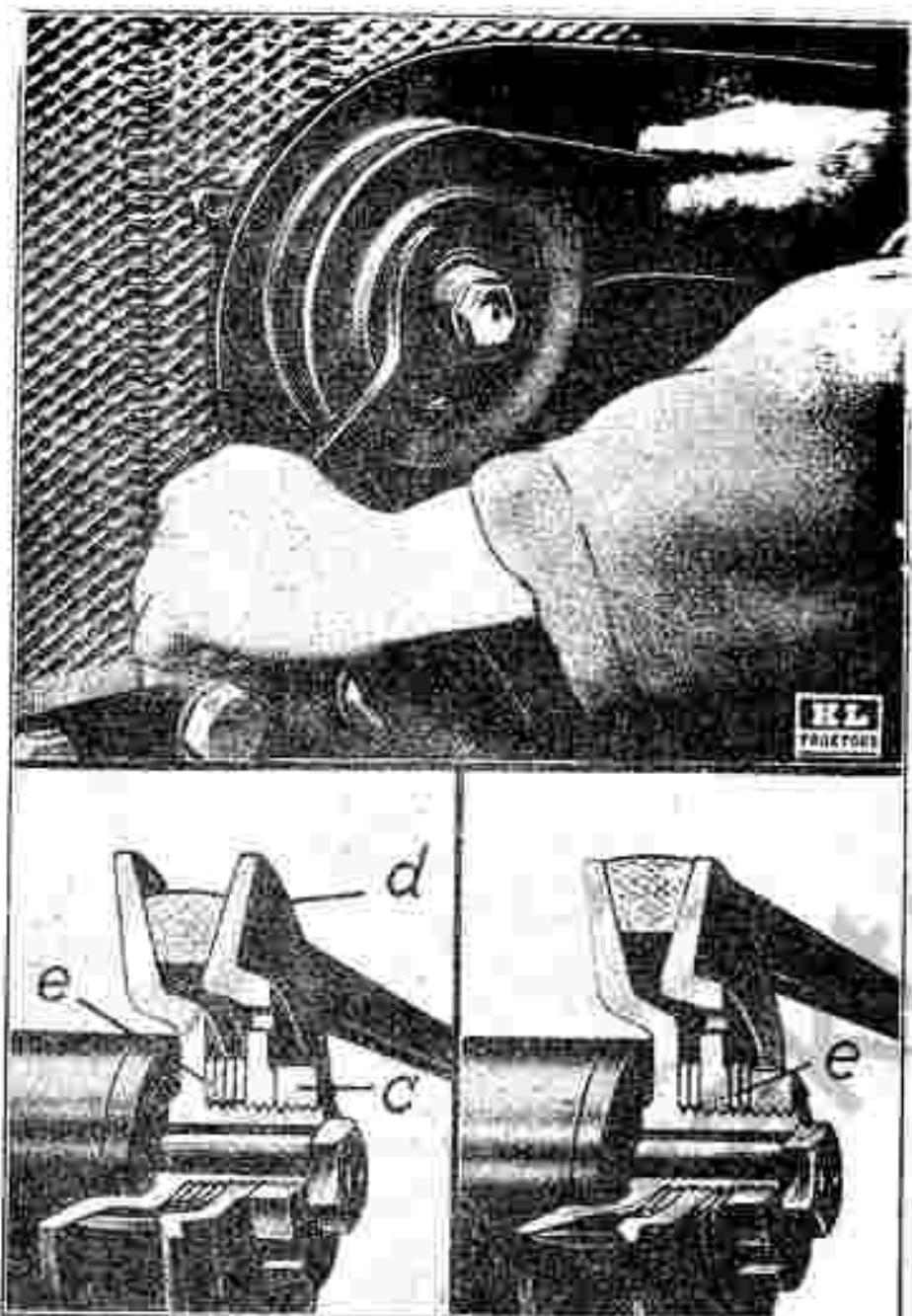
Fig. 13. Tightening of fan belt.
